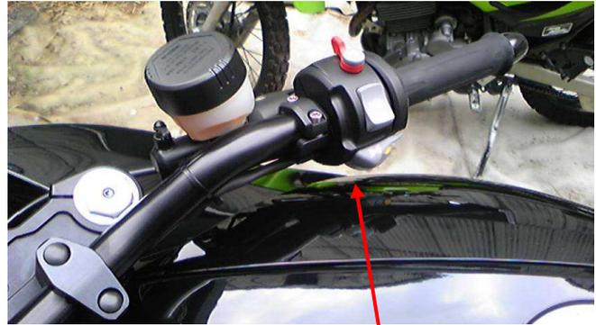
タンクとスイッチ隙間約15mm
